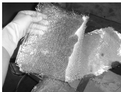
Figura 2 – Placa fabricada sem rede de distribuição
