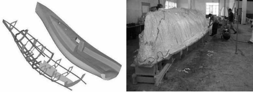
Figura 9 Imagem de Análise de Elementos Finitos e Foto de Processo de Vácuo na Construção
