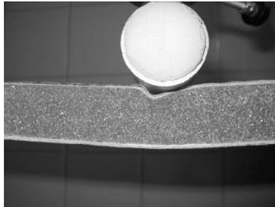
Figura 15 Pormenor do Indentador no Ensaio de Flexão (3 Pontos)
